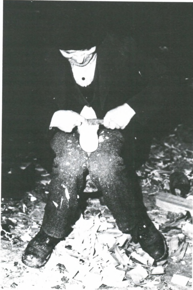
Die Herstellung der Holzpantoffel (socoli) aus Eichenholz
